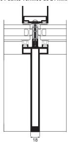
Tapeta rectangular de 14, 19 y 100 mm. de profundidad. Tapeta en H de 34 mm. de profundidad.
